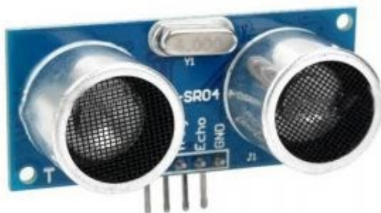
Rysunek 4 Czujnik ultradźwiękowy HC-SR04
