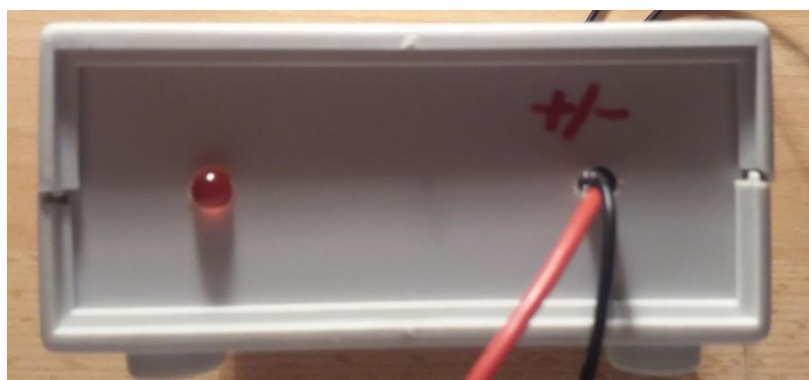
Rysunek 2 Widok panelu przedniego zestawu do badania indukcyjnego czujnika oddechu z diodą sygnalizującą załączenie zasilania
