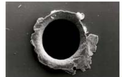
Dziura w sondzie Solar Max zrobiona przez kosmiczny odpadek © NASA
