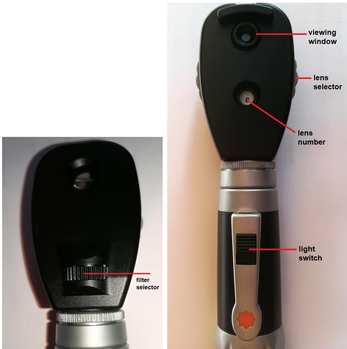
Fig. 4 Ophthalmoscope elements
